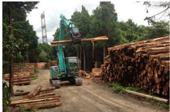
間伐材等から低質材を仕分ける機械 （グラップル付バックホウ）
