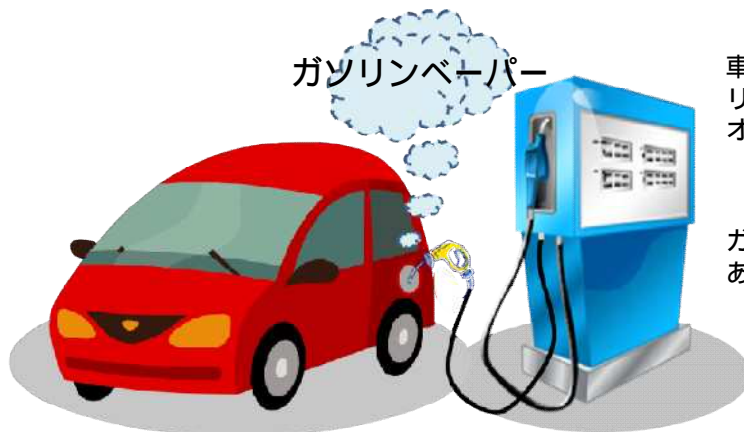
ORVR車はガソリンベーパーの放出を抑制します。
