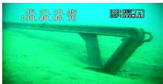
図 4 - 1 アンカーの設置状
