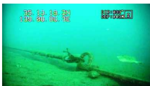
図 4 - 3 アンカーとワイヤーの連結部分
