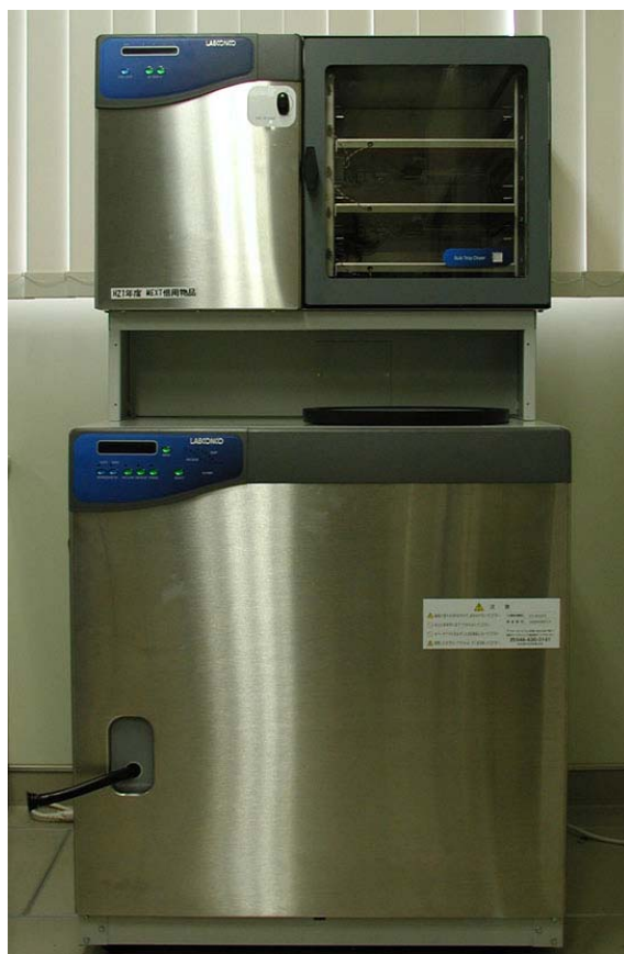
河川底質、海底土を乾燥するために、2009年新たに整備した凍結乾燥機
