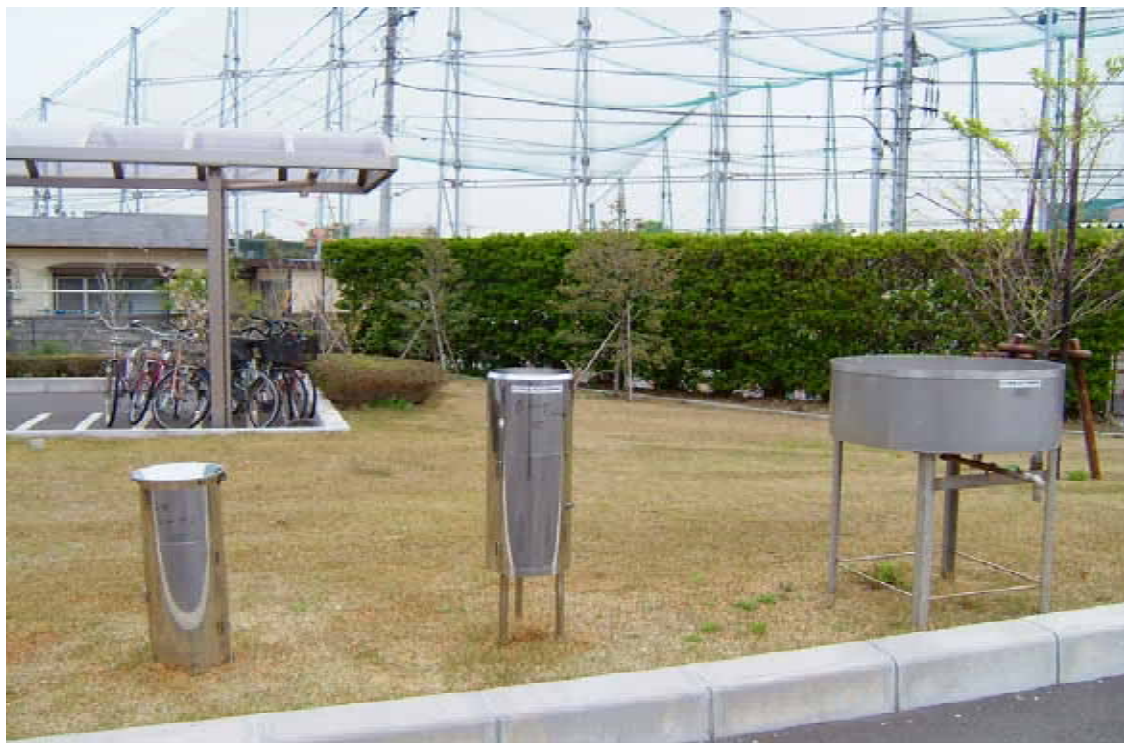
向かって左から、定時雨水採取器（核種分析測定用）・（全ベータ測定用）、月間降水物採取用大型水盤
