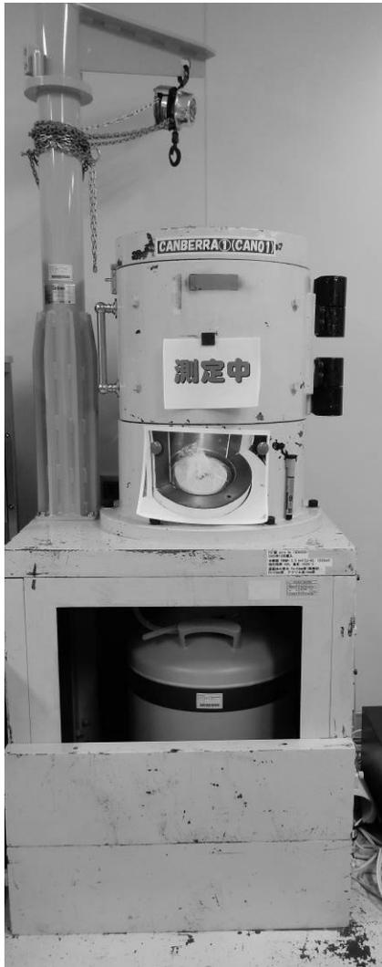
ゲルマニウム半導体検出器を用いたガンマ線スペクトロメータ(ミリオンテクノロジー・キャンベラ株式会社 ゲルマニウム半導体検出器：GC4018 マルチチャンネルアナライザー：DSA-LX)。2018年度購入、2018年12月に納品。
