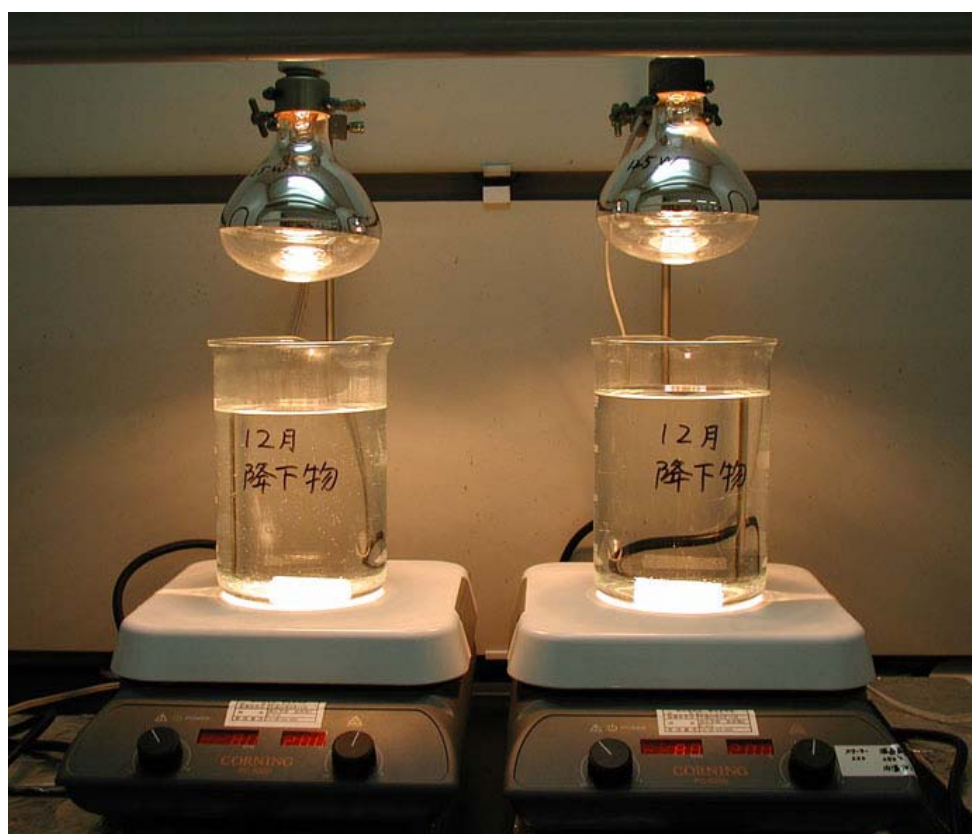
月間降水物、上水や海水を加熱濃縮するために、2010年に更新したホットプレートスターラー
