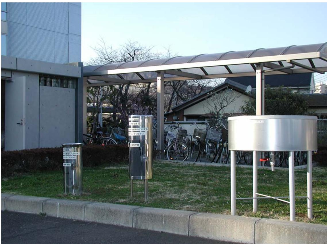
向かって右が、2011年に更新した大型水盤。1カ月間の雨水やちり（月間降下物）を採取する。また通常時は、真ん中が全ベータ測定用、その左が核種分析測定用定時雨水採取器。緊急時は、真ん中のものを核種分析測定用降下物採取器として使用した。
